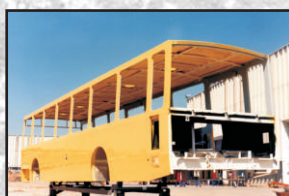
Spray de poliuretano sob teto
